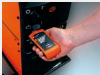
DataGun 设备也可用作对焊机的设置数据进行备份与恢复的工具。
