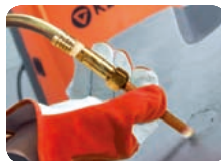
通过HotSpot™功能, 可简单而方便地实现钣金整形。
