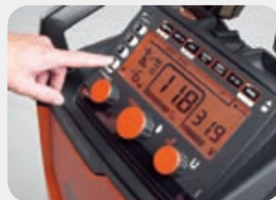
Kempact 协同控制(A) 型号包括一些特殊功能，包括通过板厚控制进行功率设置，可选择填充焊丝，以及具有记忆通道。
