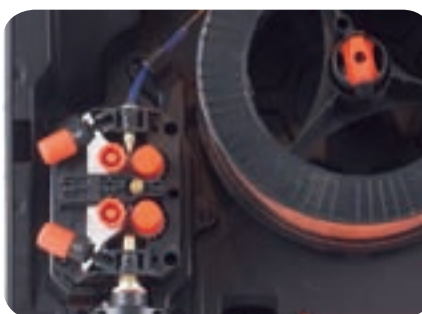
Kempact 253/323 型焊机包括 DuraTorque 四轮送丝机。
