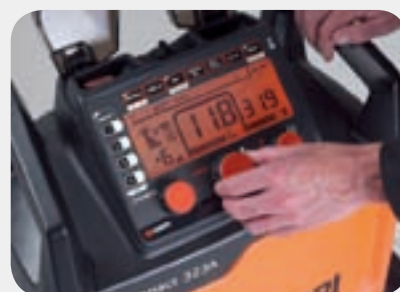
宽大而清晰的LCD 控制面板便于进行MVU 参数设置和参考。零件盒方便储存和拿取。
