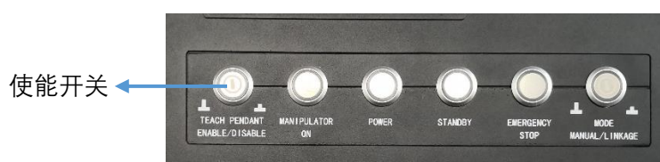
图 7-8 示教器使能开关位置
