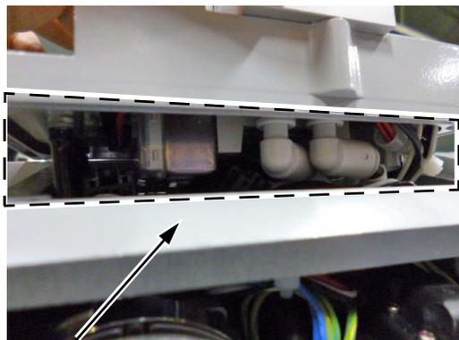
目测确认电缆和气管是否被夹，气管是否折断。
