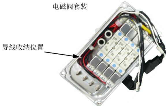
b) 将前臂内的抓手输出电缆的连接器：GR1、GR2 连接至电磁阀套装的连接器。
