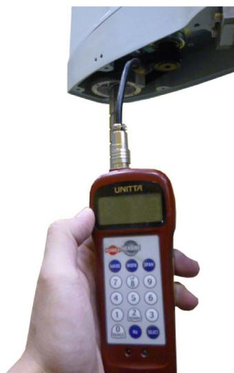
图 5-7：同步皮带的张力调整手段
