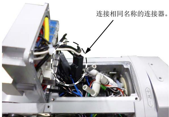
c) 将连接的连接器收纳至下图的位置。
