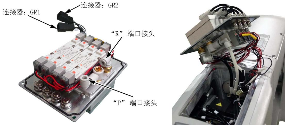
c) 连接内装于腕部的配管。(仅限接线·配管内置规格)
