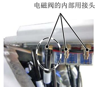
应将 2 次配管用  $\phi 4$  气管按上图所示牢牢插入至接头的根部。
