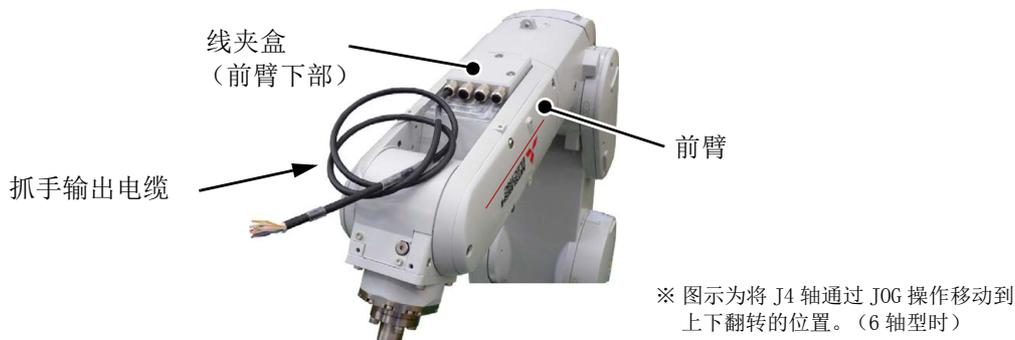
图 3-7：抓手输出电缆引出示意图
