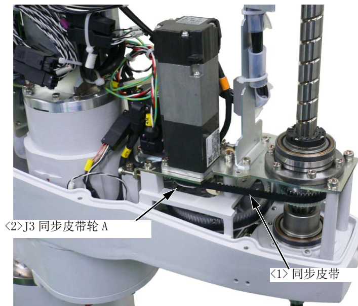
图 5-13：J3 轴同步皮带的点检（RH-3FRH）
