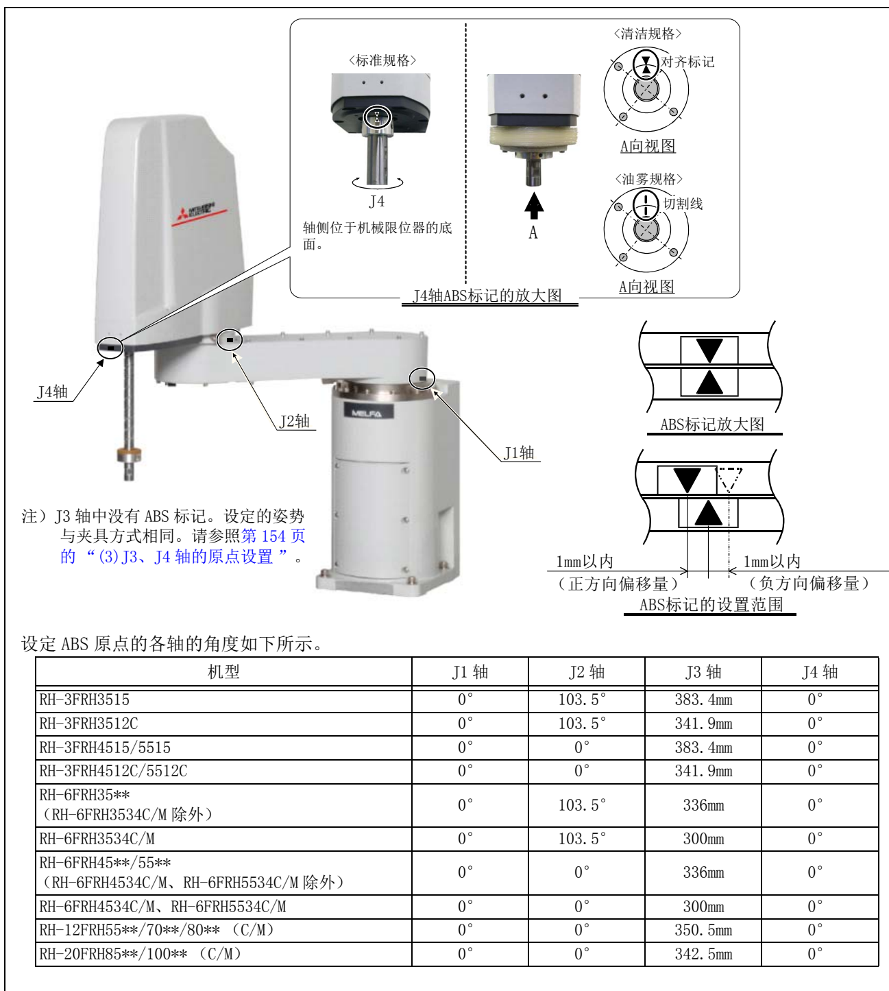
图 5-31: ABS 标记的粘贴位置 (RH-3FRH/6FRH/12FRH/20FRH 系列)
